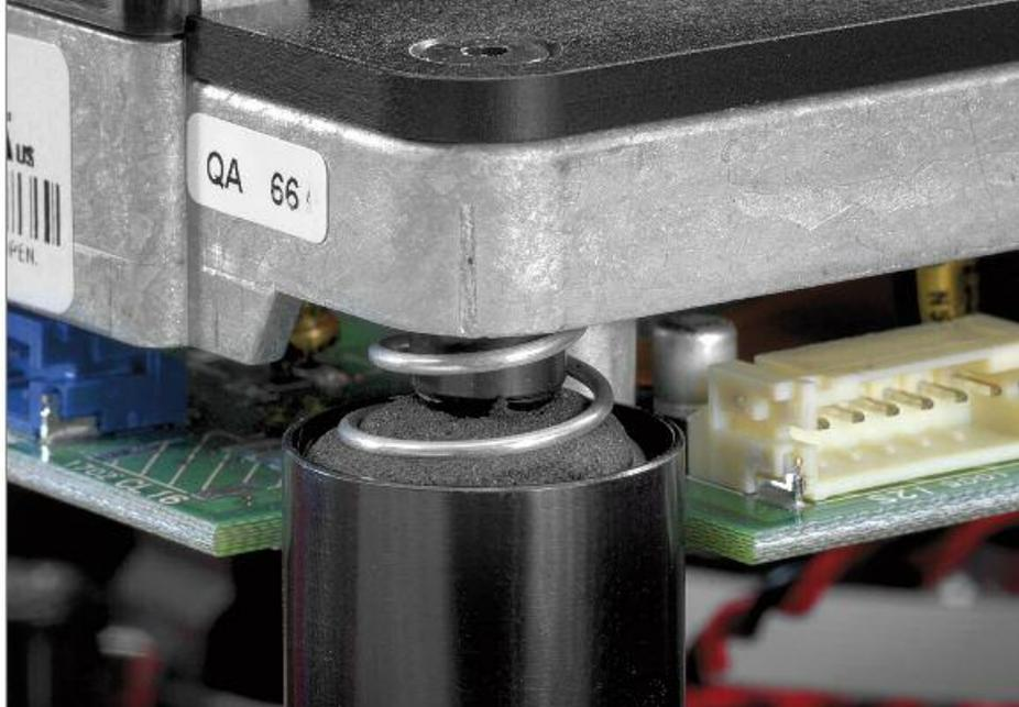
Ein Subchassis wie aus dem Bilderbuch. Bereits ganz am Anfang des Signalflusses steht eine möglichst fehlerfreie Datenauslese. Dem Audio Note (UK) Entwicklerteam ist hier ein Meisterwerk gelungen
