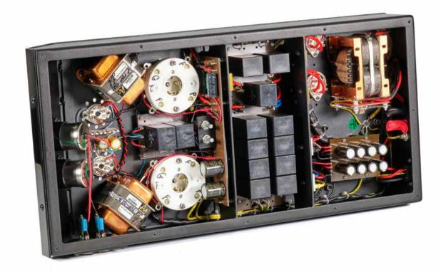
Umwege kommen für Audio Note nicht in Frage! Signale durchlaufen die Verstärkung des Tomei Kensei auf kürzestmöglichen Pfaden. Als Zugeständnis an diese Vorgabe liegt der Eingang an einem ungewohnten Ort: vorne an der linken Gehäuseseite. Im Bild ist er an den blauen Bauteilen unten links zu erkennen.
