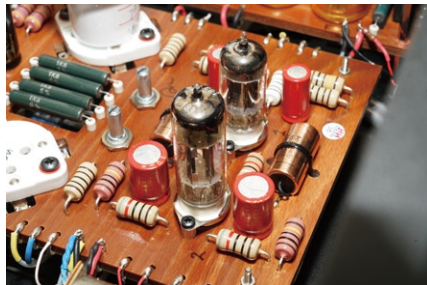
J. CV4068與6463雙三極管，以動態強又生動見稱的輸入/驅動真空管之配搭
