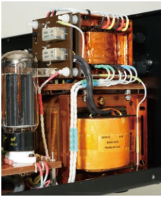
D. Audio Note自家製雙C芯電源變壓器
