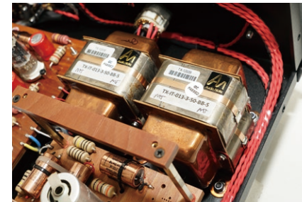
K. 級間阻抗變換變壓器（50% Perma，純銀線繞輸入/輸出級）
