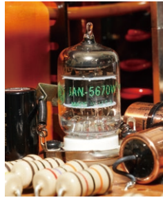
E. M8 Phono MM唱放部分採用多重獨立屏蔽，以三支JAN 5670W作兩級放大，並大量採用Audio Note名貴純銀的薄膜非磁性電容器及Tantalum鉭膜非磁性電阻器，全銀兼手工搭棚式接駁電路製作，全採用經處理的實木夾板充當電路基板
