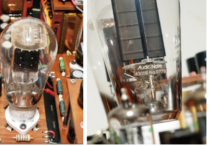
I. 功率放大級真空管4300E（Audio Note專有300B膽型號）
