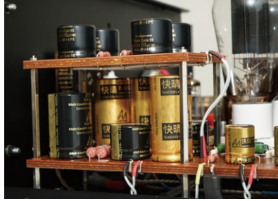
H. 供電部份更大量使用Audio Note Standard及KAISEI無極性電解質電容器，但沒有加入Regulator（穩壓器）
