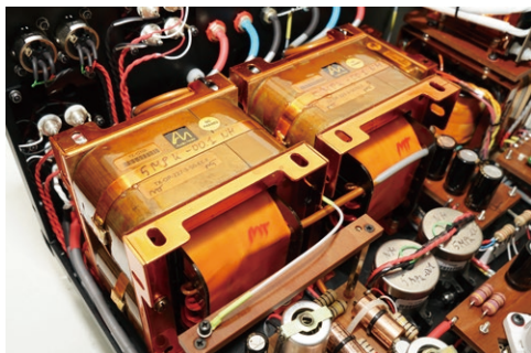
A. 輸出變壓器（50% Perma，純銀線繞輸入/輸出級）
